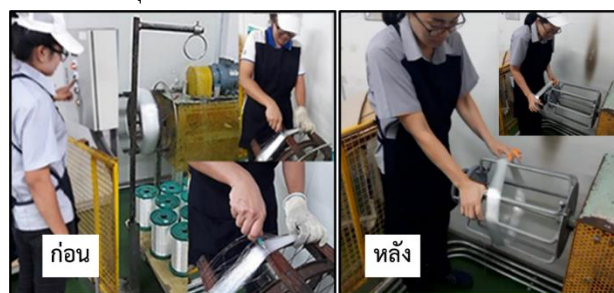
ภาพที่ 3 (a) ภาพก่อน , (b) ภาพหลังการปรับปรุง ในการนำด้วยออกจากวงล้อของเครื่องลอกด้วย
